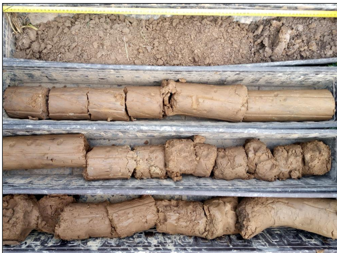
Obr. 1: Fotodokumentace vývrtu J1. Vývrt je ukládán zleva doprava a shora dolů. Ze snímku je zřetelně patrný průběžný pokles stavu konzistence zeminy.
